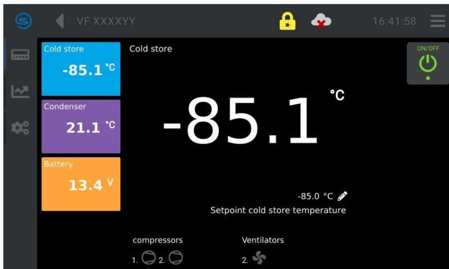
Los tres grandes símbolos de color del lado izquierdo de la pantalla indican la temperatura real en los puntos importantes de la cámara frigorífica (campo azul) y el condensador (campo violeta), el campo naranja muestra la tensión en la batería interna. En la fila inferior de la pantalla debe reconocerse si el equipo es de una etapa o de dos. Si los símbolos rotan, los compresores o el ventilador interno en el condensador están en funcionamiento. Los demás símbolos significan lo siguiente:
