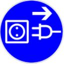
Antes de iniciar los trabajos de mantenimiento y reparación es necesario desconectar el equipo de la red eléctrica en todos los polos. (extraer el conector de red).
